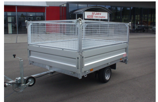
stabiler Maschengitteraufsatz, verzinkt
