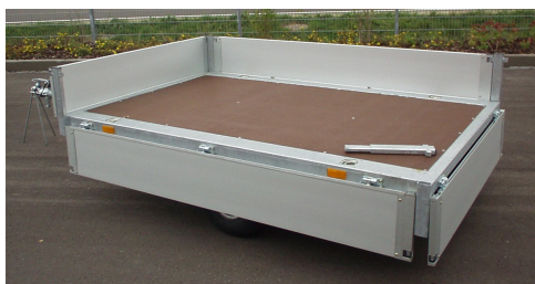
Steckbare Eckrungen, Siebdruckboden
