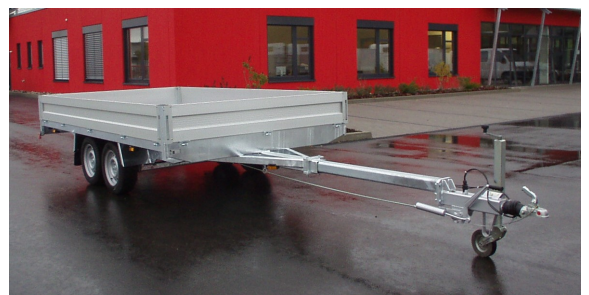
Stufenlos ausziehbare Deichsel Bremsgestänge stellt sich beim Verstellen der Deichsel mit ein
