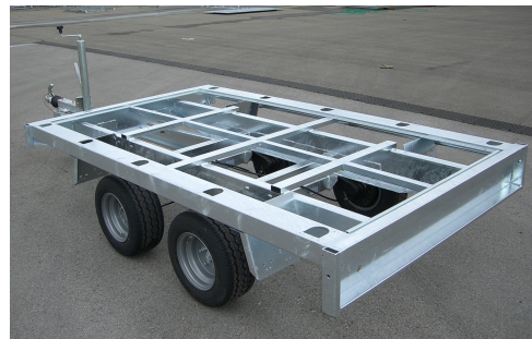
Rampentunnel unter der Pritsche
